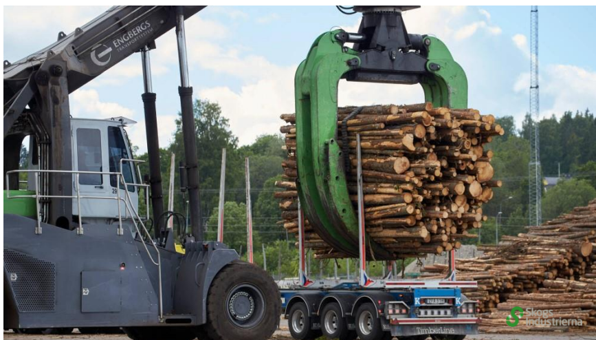
Bild 5: Vid de större industrierna finns truckar som lastar av större travar från lastbilar och järnvägsvagnar.
